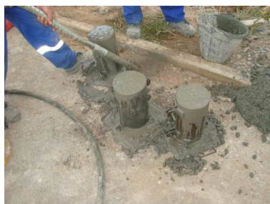
Contrôle qualité : confection d'éprouvettes 16/32
