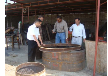
Contrôle de la fabrication des tuyaux ovoïdes
